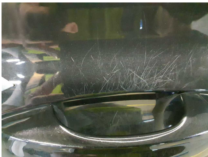
Beschädigung 3: Tür vorn links: Tür - verkratzt / verschürft - lackieren
