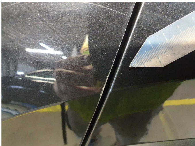
Beschädigung 4: Tür hinten links: Tür - verkratzt / verschürft - lackieren
