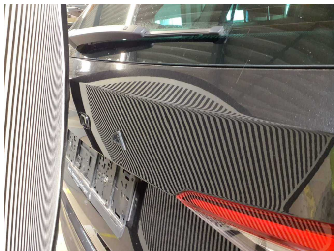
Gebrauchsspur 4: Heckklappe/-tür: Heckklappe - Delle(n) - sanft instandsetzen
