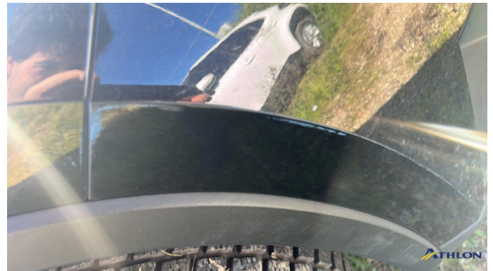
6. Parafango anteriore - destro Usura
