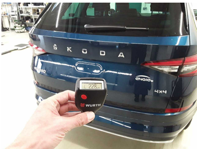
Boot lid / rear door: 228 µm
