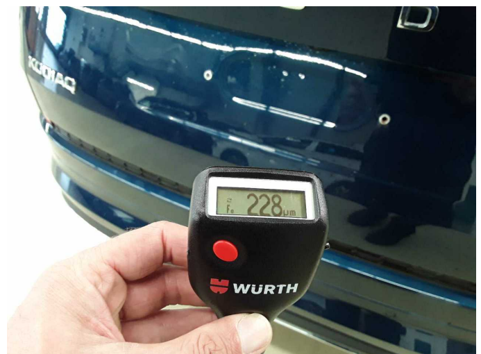
Boot lid / rear door: 228 µm
