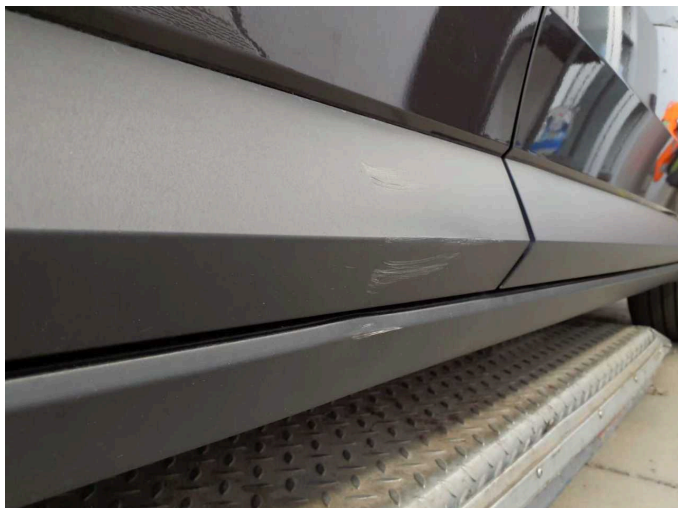
Damage 11: Body: Body (Radlauf, Schweller, Verkleidung, Türzierleiste) - Scratched - Replace
