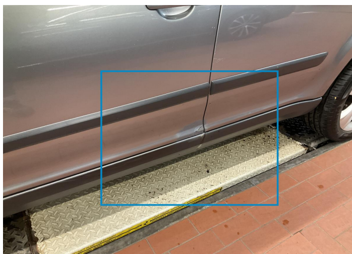
15. Door / Front Left Paint / Corrosion -
