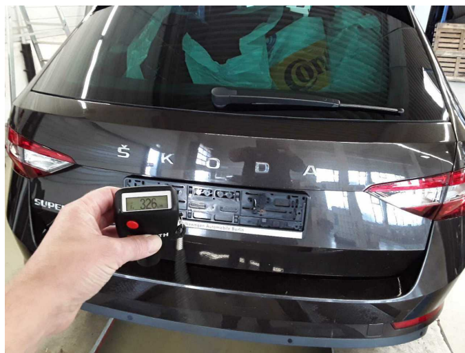
Boot lid / rear door: 326 µm
