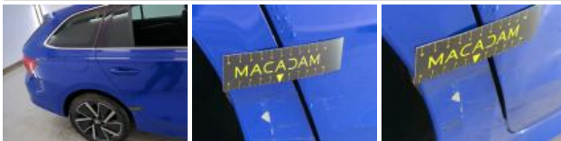
Porte ARD, Griffe(s), LI - Réparer et peindre (partiel.)
