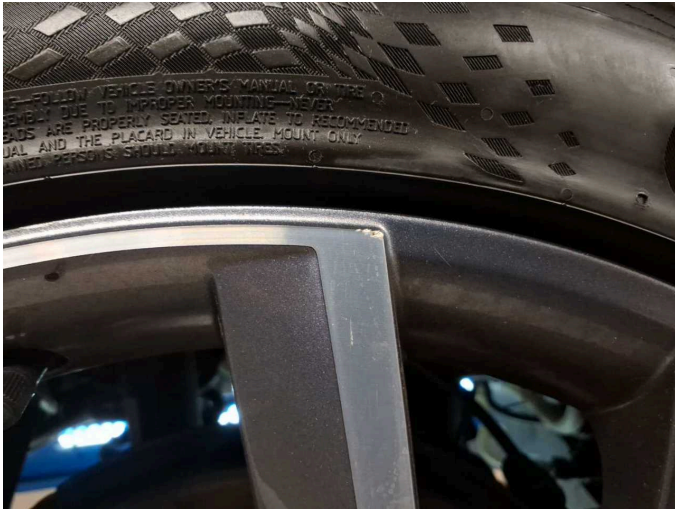
Damage 17: Wheel / tyres: Alloy rim - rear right side (Mit Materialabtrag) - Scratch(es) - Replace
