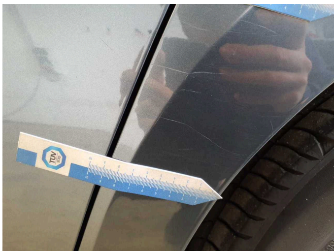
Beschädigung 13: Seitenwand links: Seitenwand - Kratzer - lackieren
