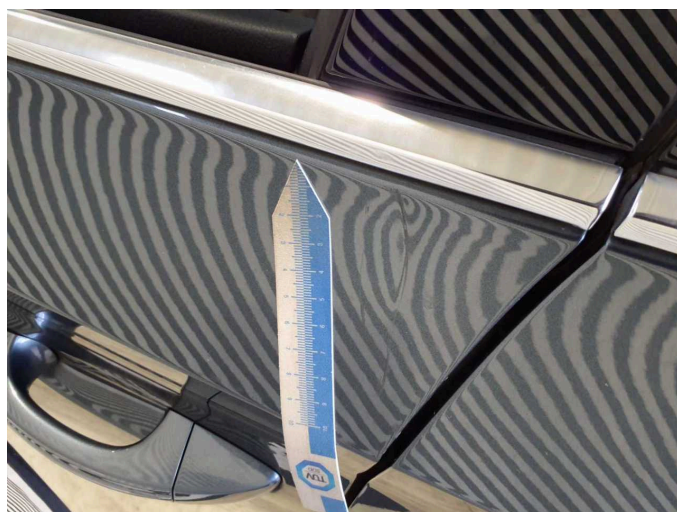
Beschädigung 10: Tür vorn links: Tür - verformt - instandsetzen und lackieren
