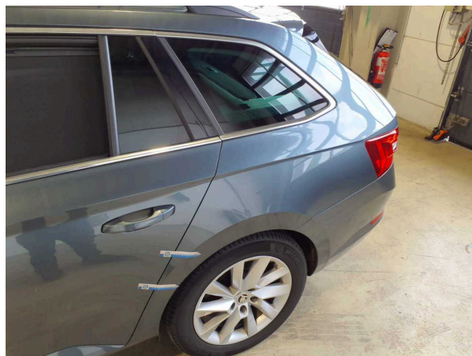
Beschädigung 13: Seitenwand links: Seitenwand - Kratzer - lackieren
