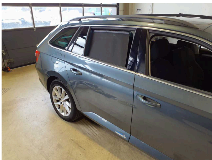
Beschädigung 7: Tür hinten rechts: Tür (Zierleiste) - Kratzer - Smart Repair
