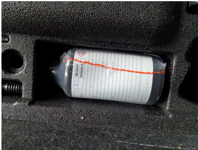
Beschädigung 1: Ausrüstung: Tirefit Füllmittel - abgelaufen - erneuern
