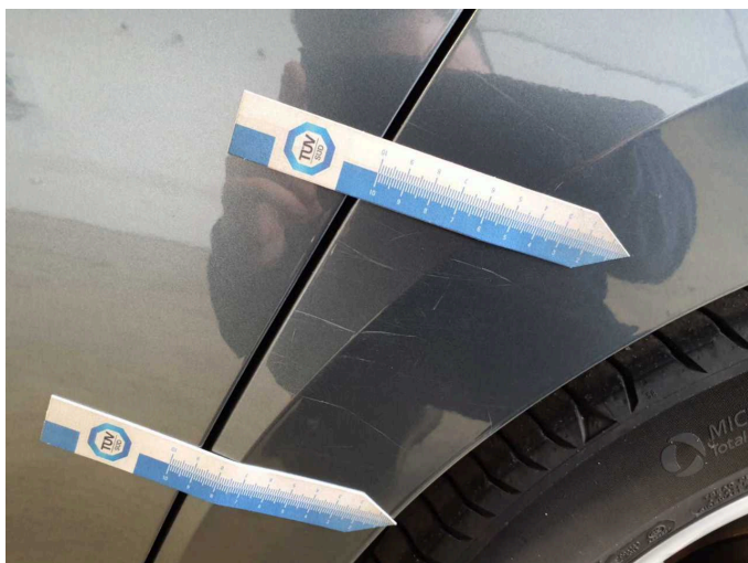
Beschädigung 13: Seitenwand links: Seitenwand - Kratzer - lackieren
