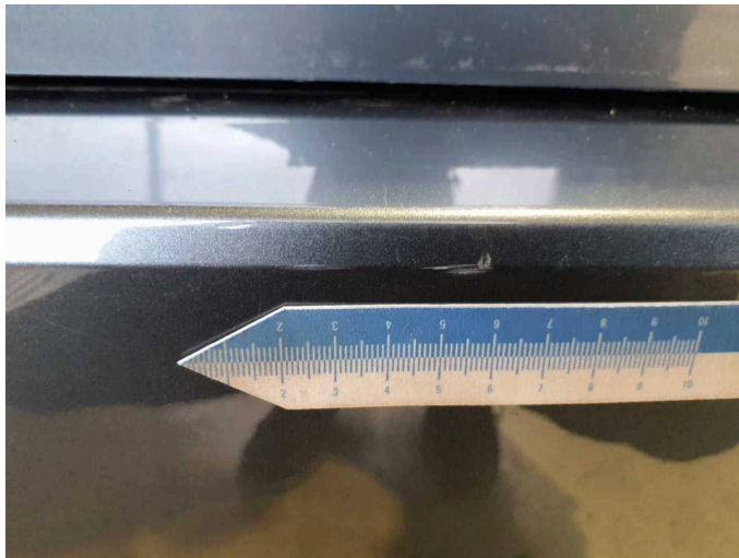
Beschädigung 12: Stossfänger hinten: Stossfänger hinten - Kratzer - lackieren
