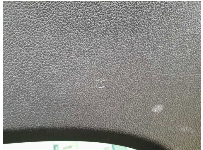
Beschädigung 2: Verkleidungen/Abdeckungen: Heckdeckel, Innenverkleidung - Kratzer - Wertminderung
