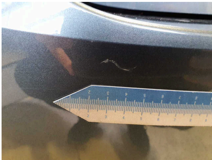
Beschädigung 12: Stossfänger hinten: Stossfänger hinten - Kratzer - lackieren
