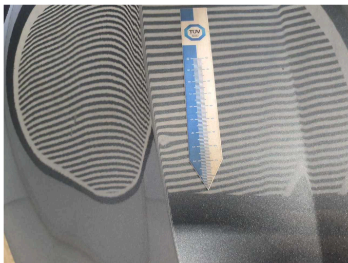
Beschädigung 5: Motorhaube: Motorhaube - Delle(n) - Smart Repair
