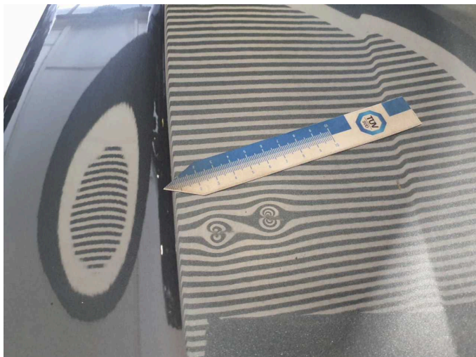
Beschädigung 5: Motorhaube: Motorhaube - Delle(n) - Smart Repair
