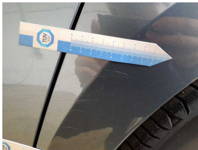
Beschädigung 13: Seitenwand links: Seitenwand - Kratzer - lackieren
