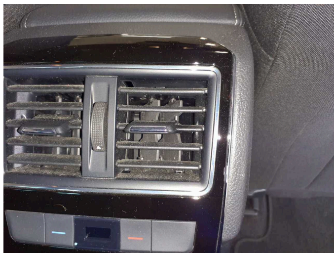
Beschädigung 9: Instrumententafel: Luftdüse Mitte (Hinten) - beschädigt - erneuern
