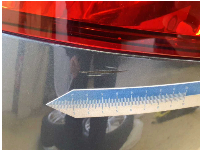
Beschädigung 12: Stossfänger hinten: Stossfänger hinten - Kratzer - lackieren
