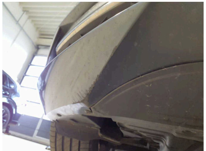
Beschädigung 11: Stossfänger vorn: Stossfänger vorn - Delle / Lackschaden - instandsetzen und lackieren
