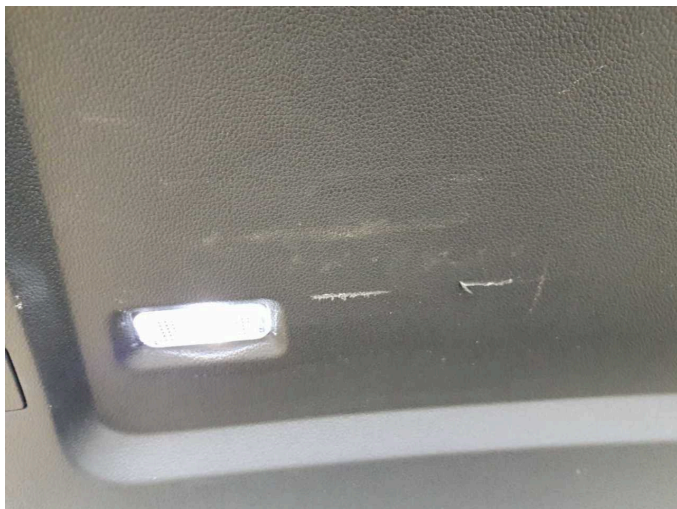
Beschädigung 2: Verkleidungen/Abdeckungen: Heckdeckel, Innenverkleidung - Kratzer - Wertminderung
