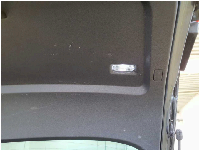
Beschädigung 2: Verkleidungen/Abdeckungen: Heckdeckel, Innenverkleidung - Kratzer - Wertminderung
