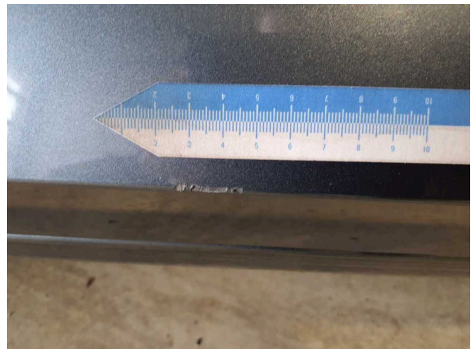
Damage 7: Door - rear right side: Door (Zierleiste) - Scratch(es) - Smart repair
