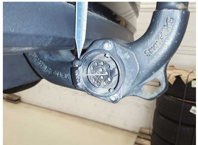
Beschädigung 3: Heckbereich: Anhängerdose - gebrochen / gerissen - erneuern
