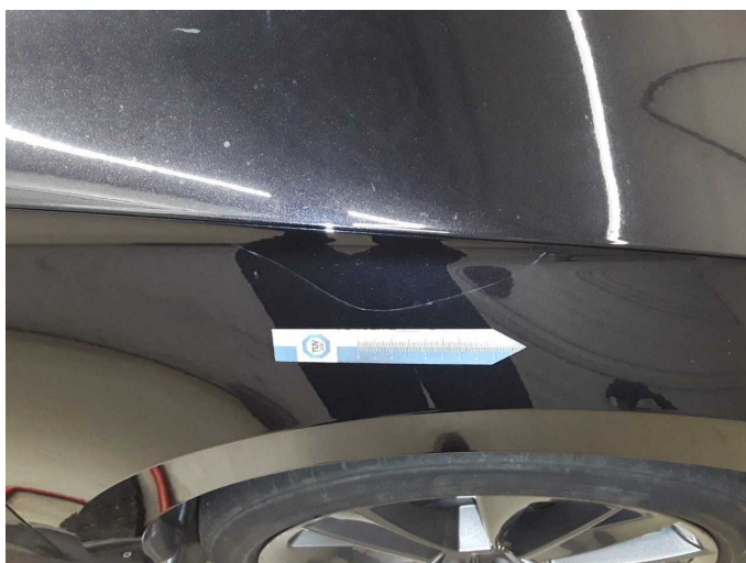
Beschädigung 8: Kotflügel rechts: Kotflügel rechts - Kratzer - lackieren
