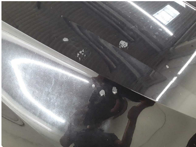
Beschädigung 1: Motorhaube: Motorhaube (Baumharz) - verschmutzt - reinigen
