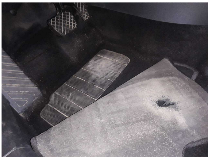
Gebrauchsspur 5: Verkleidungen/Abdeckungen: Fußmatten - gebrochen / gerissen - kein Abzug
