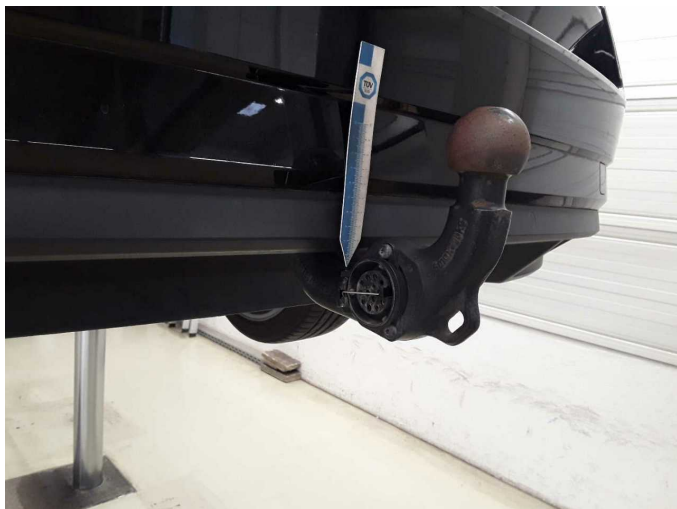
Beschädigung 3: Heckbereich: Anhängerdose - gebrochen / gerissen - erneuern
