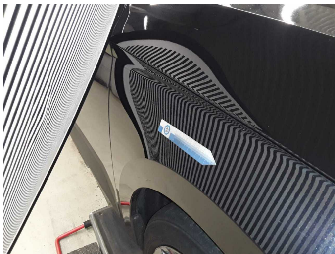
Beschädigung 8: Kotflügel rechts: Kotflügel rechts - Kratzer - lackieren
