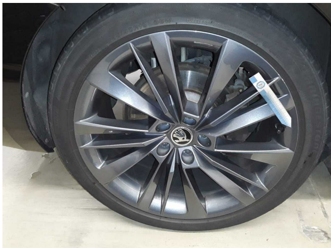
Gebrauchsspur 2: Rad/Reifen: Leichtmetallfelge hinten rechts - Kratzer - kein Abzug
