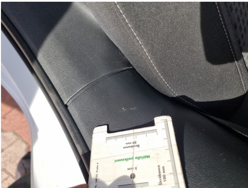
7 Vnitřní kryt levého C-sloupku dolní - Škrábance Umístění: Interiér (vnitřní prostor)
