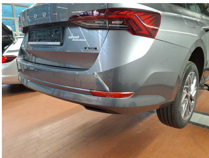
Damage 16: Rear bumper: Rear bumper (inkl. Rückstrahler rechts ersetzen) - Scratch(es) - Repair
