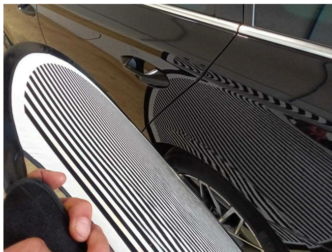
Damage 4: Side panel - rear left side: Side panel (Delle geht über die Kante) - Dent / paintcoat damage - Repair and paint
