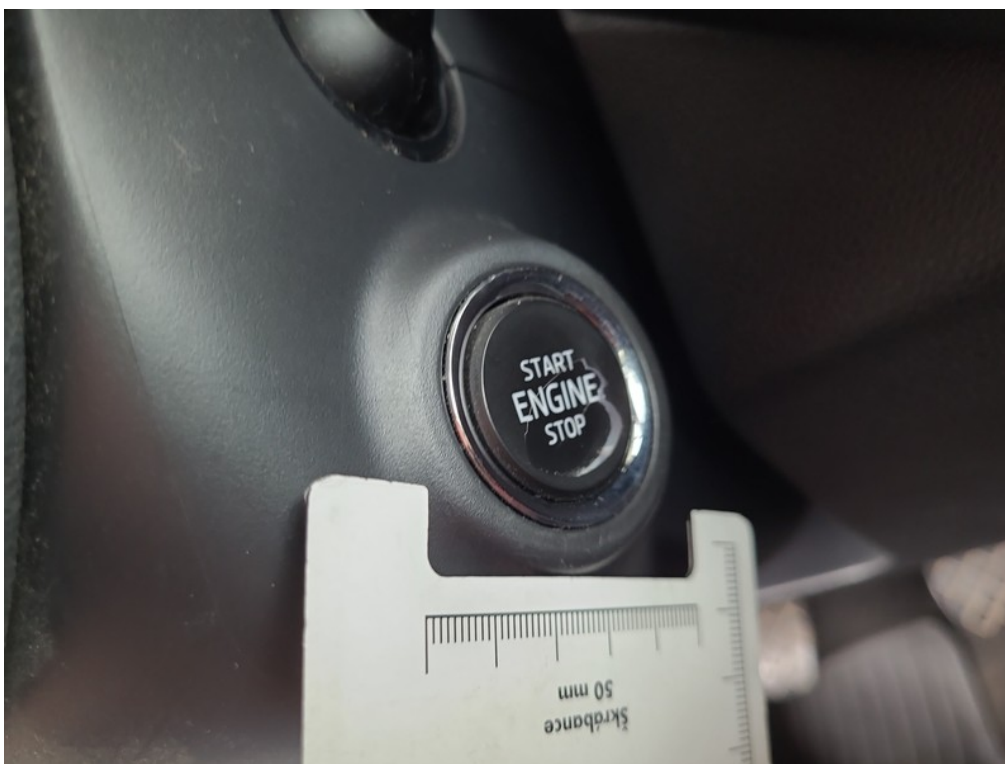
19 Startovací tlačítko - Prasklina Umístění: Interiér (vnitřní prostor)
