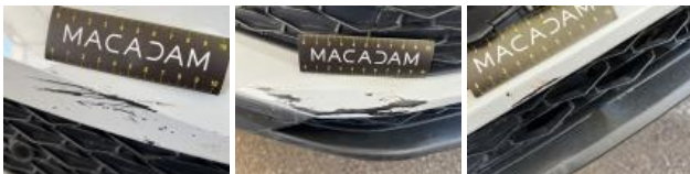
Grille de pare-chocs AV M, Déformé / Forcé, Acceptable
