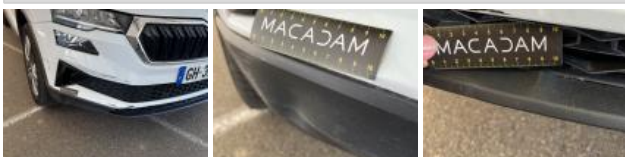
Spoiler AV, Déformé / Forcé, E - Remplacer
