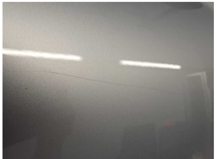
Damage 2: Door - front right side: Door - Scratch(es) - Paint
