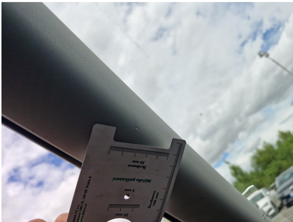
23 Vnitřní kryt levého A-sloupku horní - Škrábance Umístění: Interiér (vnitřní prostor)
