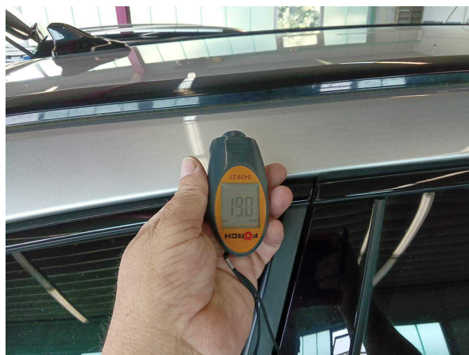
Dachholm rechts: 184 µm
