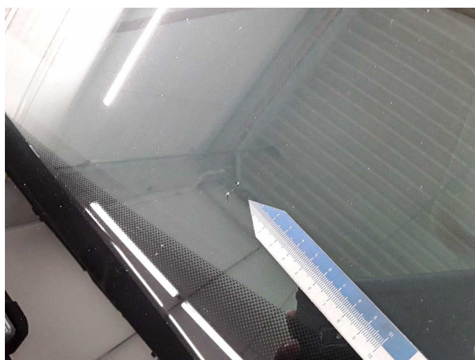
Beschädigung 5: Verglasung: Frontscheibe - Steinschlag - erneuern
