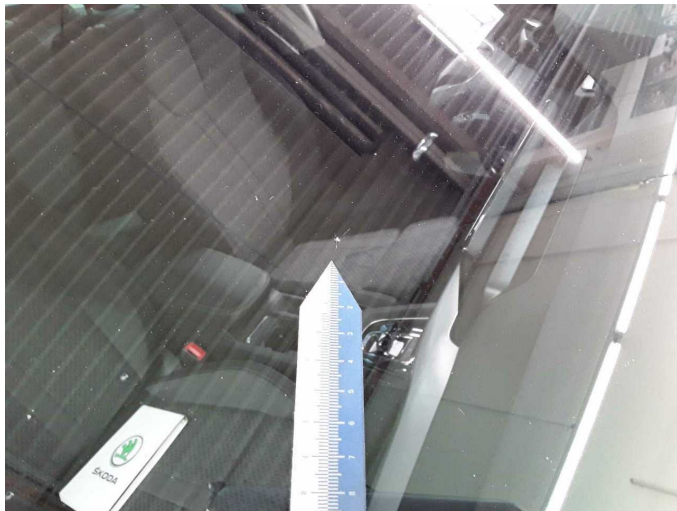
Beschädigung 5: Verglasung: Frontscheibe - Steinschlag - erneuern
