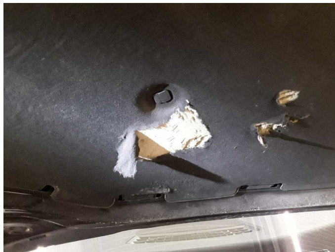
Beschädigung 3: Motorhaube: Dämmmatte - gebrochen / gerissen - erneuern
