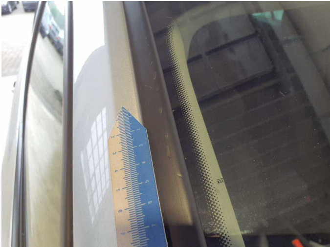
Beschädigung 3: Verkleidungen/Abdeckungen: Zierleiste / Dekorleiste (Frontscheibe rechts) - verkratzt / verschürft - erneuern
