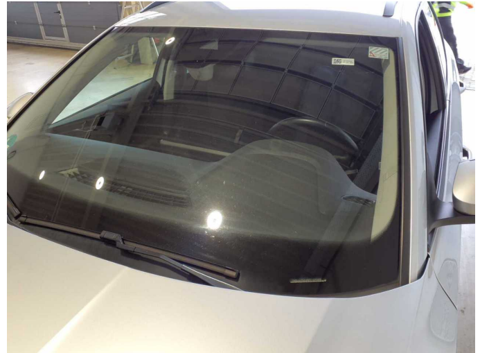
Beschädigung 14: Verglasung: Frontscheibe mit Spurhalteassistent (Sandstrahleffekt) - Steinschlag - erneuern
