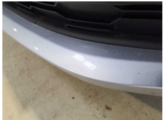
Beschädigung 13: Stossfänger vorn: Stossfänger vorn (Schleifspuren) - nicht fachgerecht instandgesetzt - lackieren
