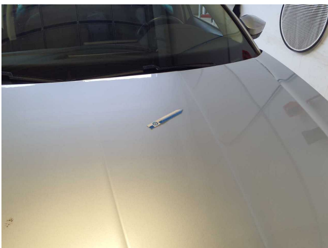
Beschädigung 10: Motorhaube: Motorhaube (Einschlüsse) - nicht fachgerecht instandgesetzt - lackieren
