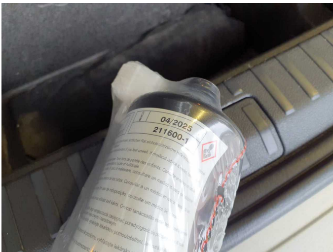
Beschädigung 2: Ausrüstung: Tirefit Füllmittel - abgelaufen - erneuern
