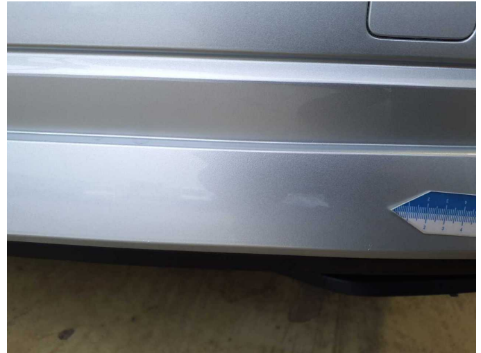
Beschädigung 11: Stossfänger hinten: Stossfänger hinten (Stellenweise Matt, Einschlüsse) - nicht fachgerecht instandgesetzt - lackieren
