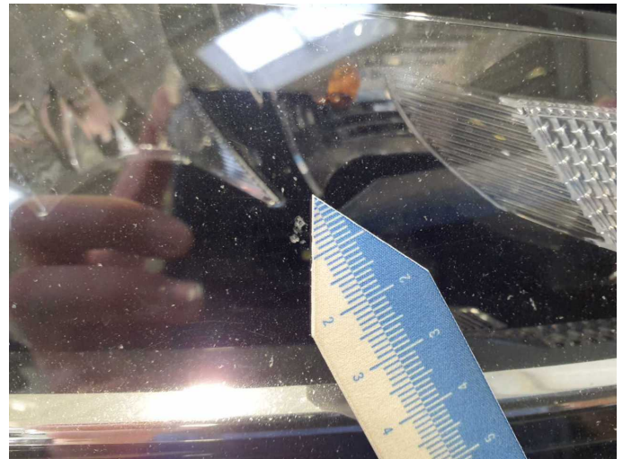
Beschädigung 7: Scheinwerfer: Scheinwerfer rechts - Steinschlag - Wertminderung
