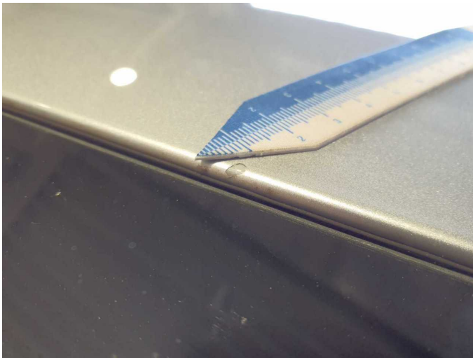
Beschädigung 15: Fahrzeugdach: Dach - Steinschlag - lackieren
