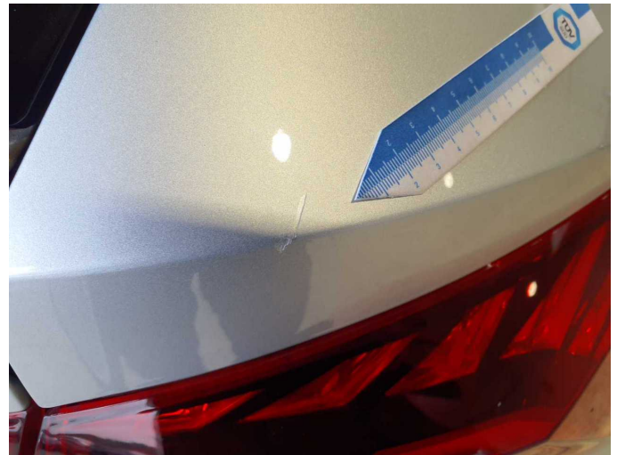
Beschädigung 12: Seitenwand rechts: Seitenwand - verkratzt / verschürft - lackieren
