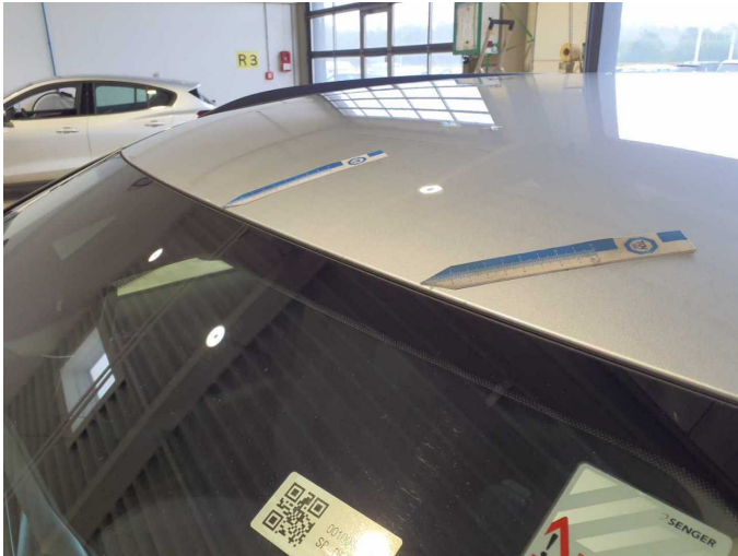
Beschädigung 15: Fahrzeugdach: Dach - Steinschlag - lackieren
