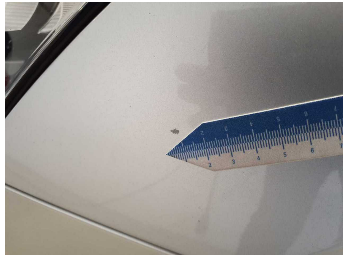
Beschädigung 9: Kotflügel links: Kotflügel links - Kratzer - lackieren
