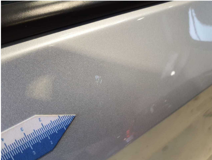
Beschädigung 8: Tür vorn rechts: Tür - Delle / Lackschaden - instandsetzen und lackieren
