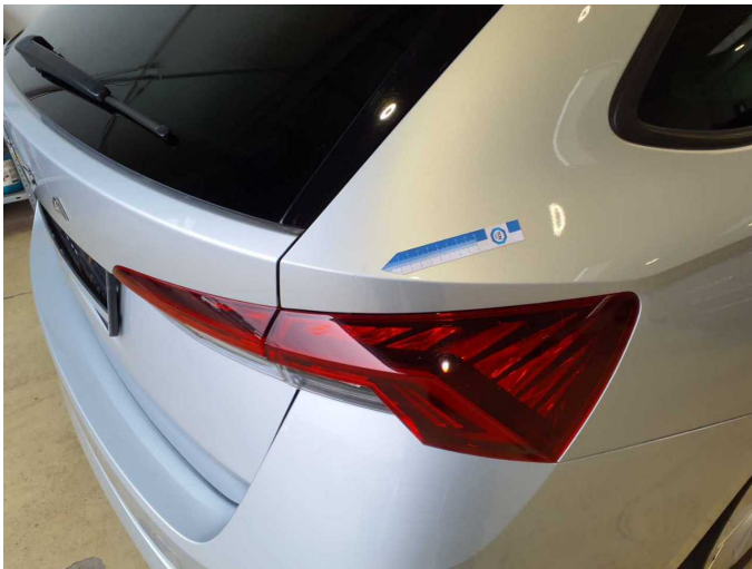
Beschädigung 12: Seitenwand rechts: Seitenwand - verkratzt / verschürft - lackieren
