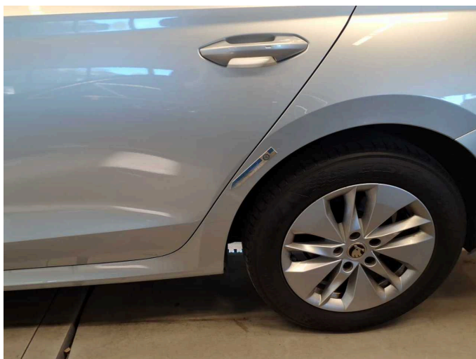
Beschädigung 4: Seitenwand links: Kniestück - Kratzer - Smart Repair
