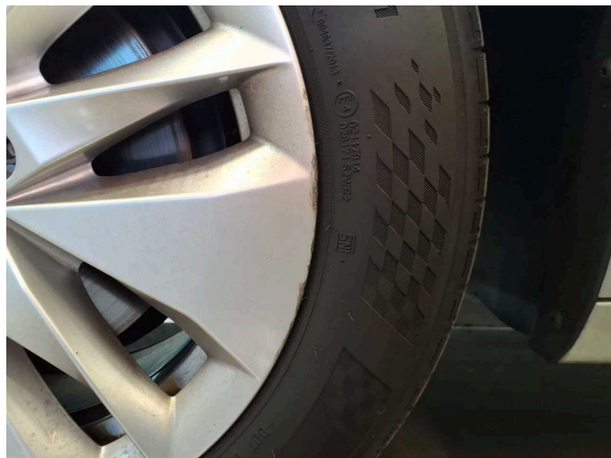
Beschädigung 3: Rad/Reifen: Leichtmetallfelge vorn links - Kratzer - Wertminderung
