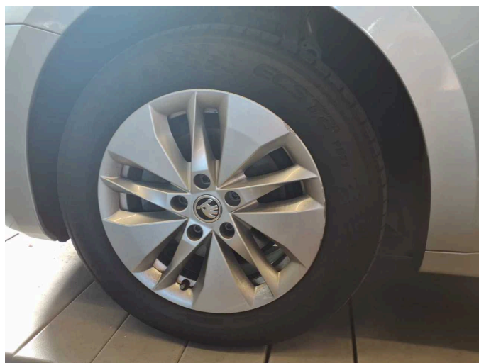
Beschädigung 3: Rad/Reifen: Leichtmetallfelge vorn links - Kratzer - Wertminderung
