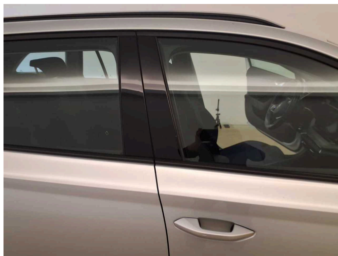
Beschädigung 2: Verkleidungen/Abdeckungen: Zierleiste / Dekorleiste (Tür VR) - Kratzer - erneuern
