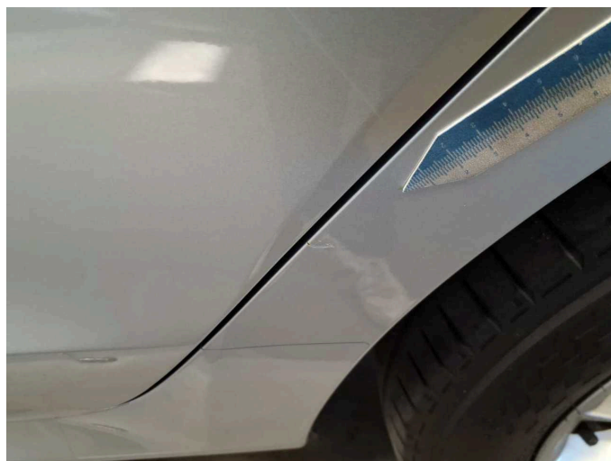
Beschädigung 4: Seitenwand links: Kniestück - Kratzer - Smart Repair
