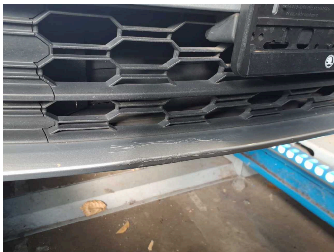
Beschädigung 5: Stossfänger vorn: Stossfänger vorn - verformt - instandsetzen und lackieren
