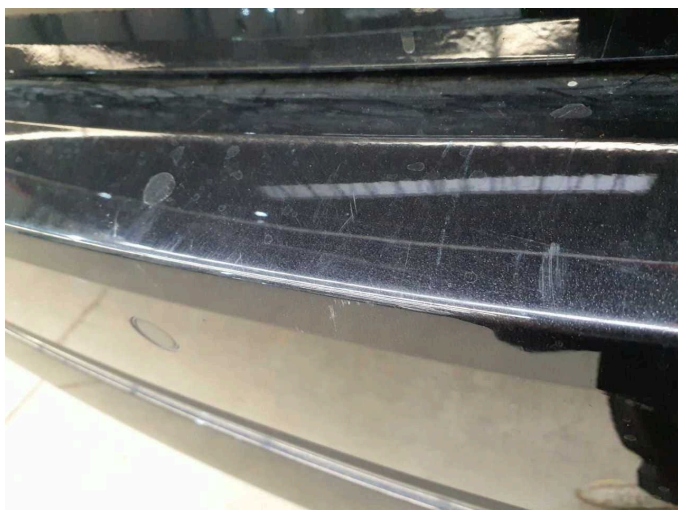
Beschädigung 5: Stossfänger hinten: Stossfänger hinten - Kratzer - lackieren
