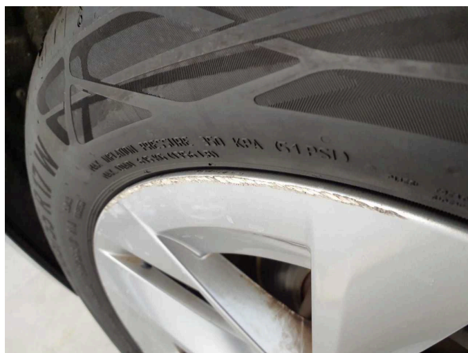
Beschädigung 4: Rad/Reifen: Leichtmetallfelge hinten rechts - Kratzer - Wertminderung
