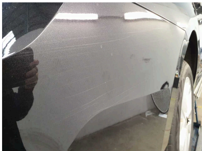
Beschädigung 5: Stossfänger hinten: Stossfänger hinten - Kratzer - lackieren
