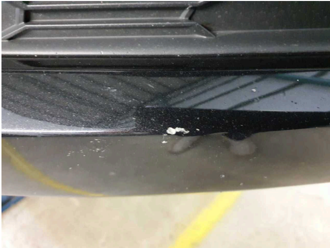
Beschädigung 6: Stossfänger vorn: Stossfänger vorn - Kratzer - lackieren
