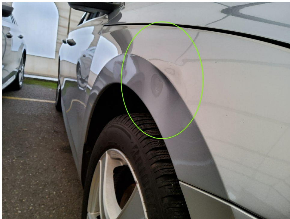
Bild 18 : Kotflügel vorne rechts deformiert
