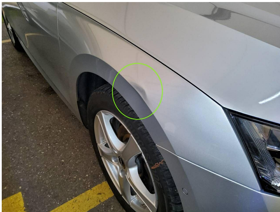
Bild 17 : Kotflügel vorne rechts deformiert
