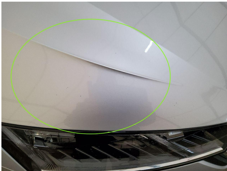
Bild 16 : Motorhaube viele Steinschläge bis auf Grundierung
