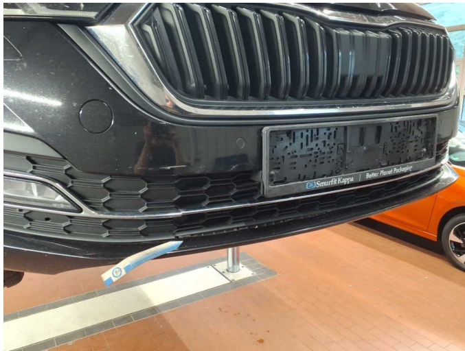
Damage 1: Front bumper: Air-inlet grille (Folgekosten möglich) - Malposition - Un- / install
