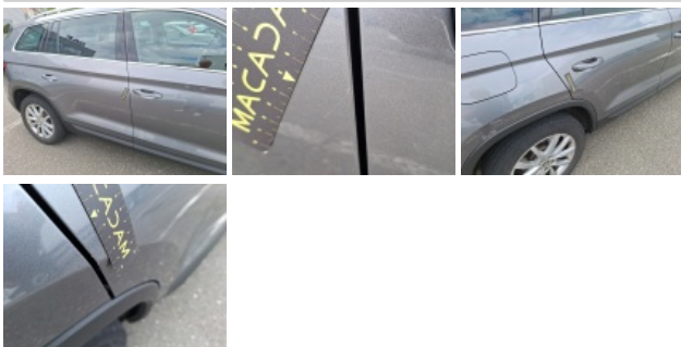
Door RR, Scratch(es), Acceptable
