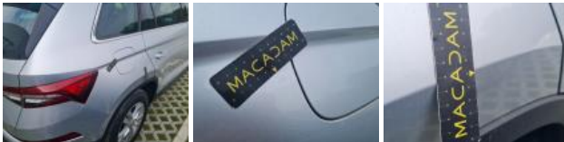
Door RR, Scratch(es), Acceptable
