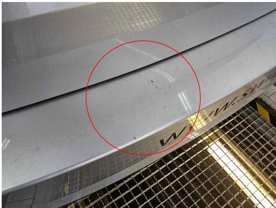
Bild 31 : Stoßfänger hinten, Kratzer
