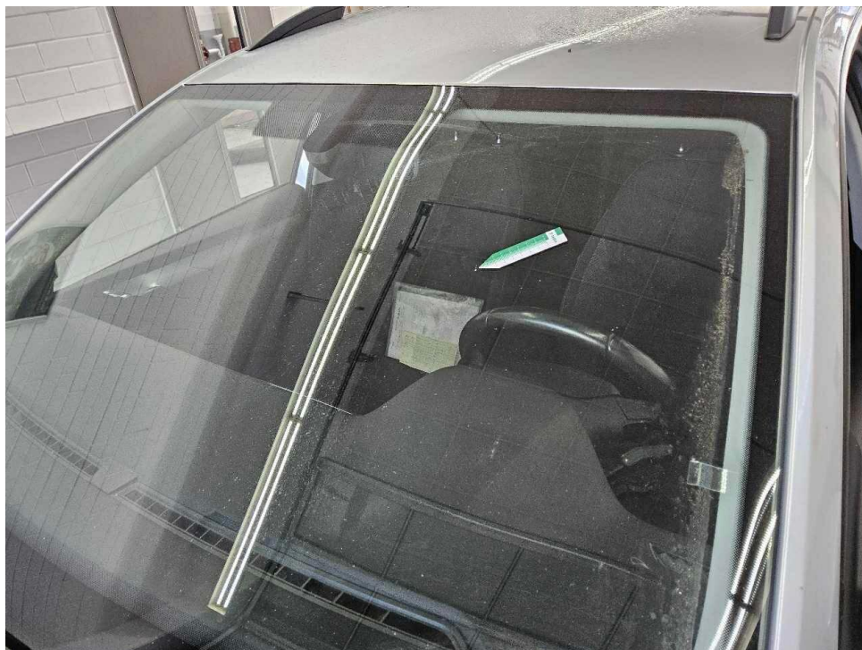
Bild 14 : Windschutzscheibe, Steinschlag mit Rissbildung
