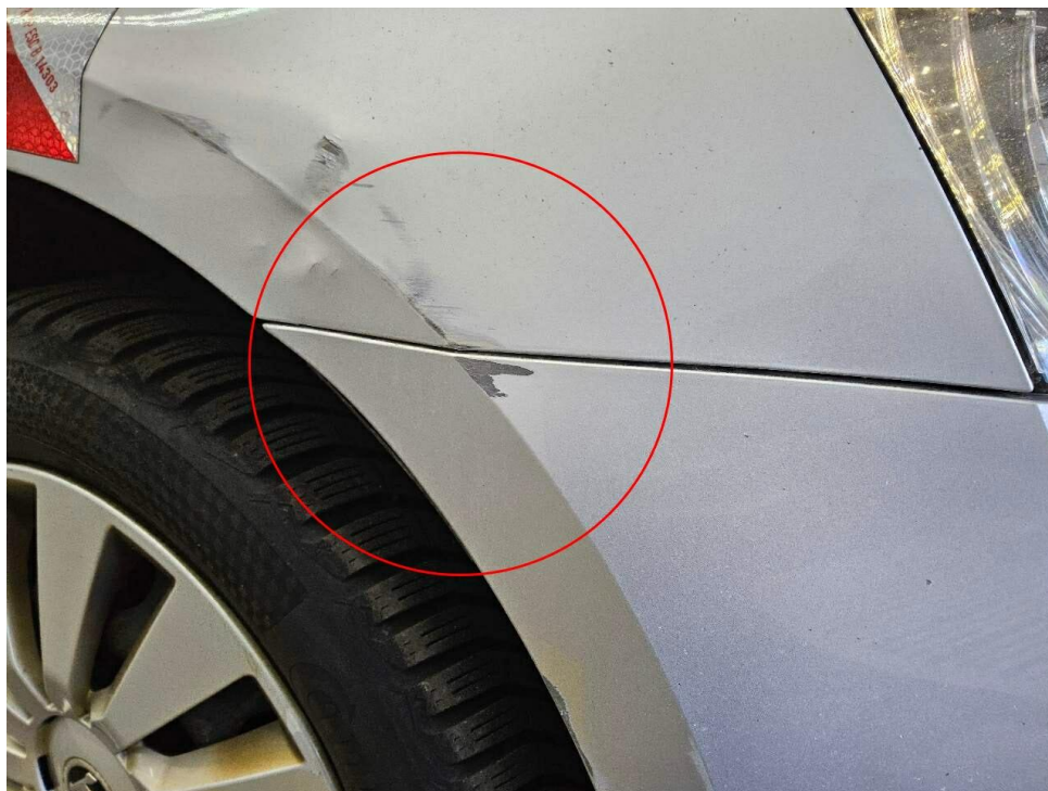
Bild 21 : Stoßfänger vorne, verschrammt/Steinschlag
