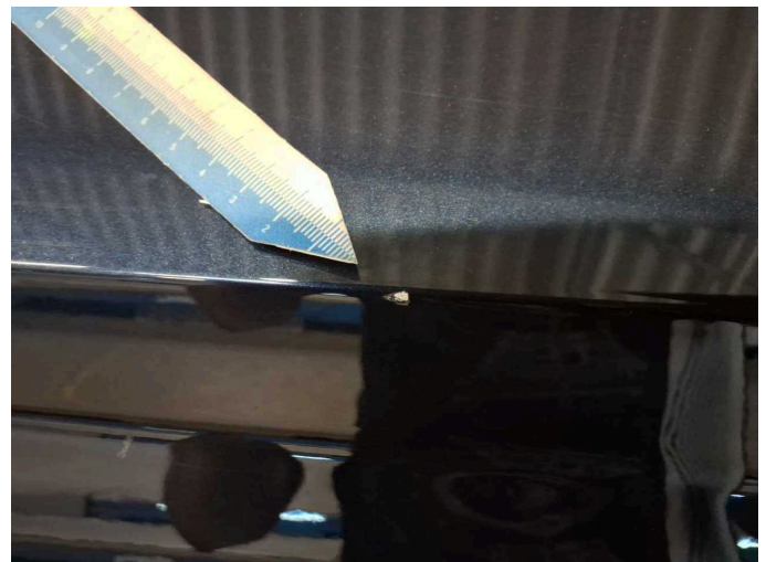
Damage 3: Door - rear right side: Door (Delle geht über die Kante) - Dent / paintcoat damage - Repair and paint
