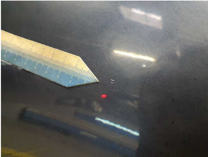
Damage 10: Door - rear right side: Door (teilweise matt) - Scratched - Paint
