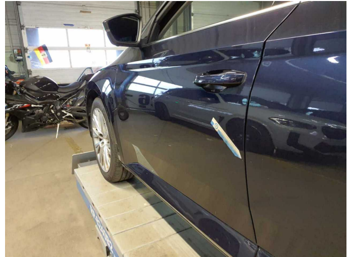
Damage 11: Door - front left side: Door (Kratzer) - Stone chips - Paint
