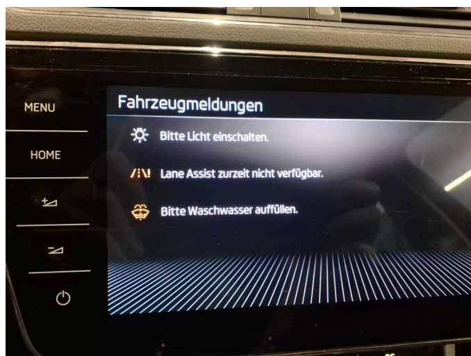
Beschädigung 4: elektronische Systeme: Spurhaltesystem - elektrischer Fehler - Diagnose durchführen
