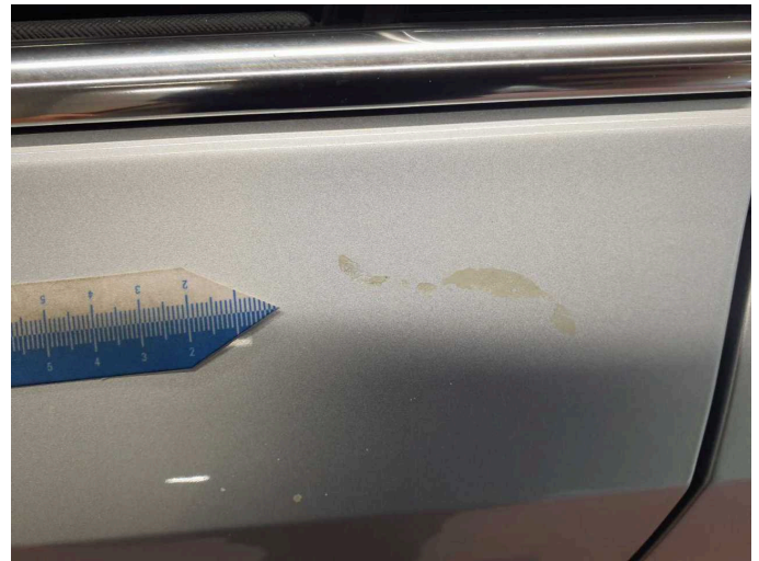
Damage 11: Door - front left side: Door (Verätzung) - Paint defect - Smart repair
