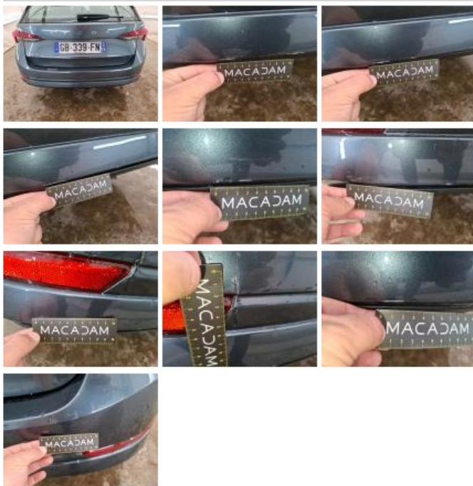
Pare-chocs AR, Déformé / Forcé, Le - Remplacer et peindre
