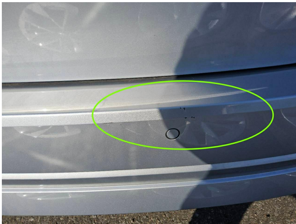
Bild 42 : Stoßfängerverkleidung hinten mehrfach verschrammt
