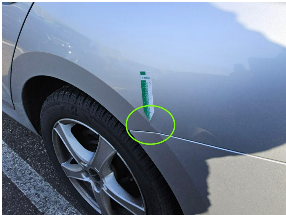
Bild 38 : Seitenwand hinten links eingedellt
