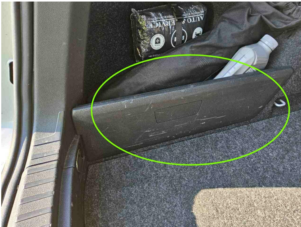
Bild 20 : Kofferraum Verkleidungen zerkratzt
