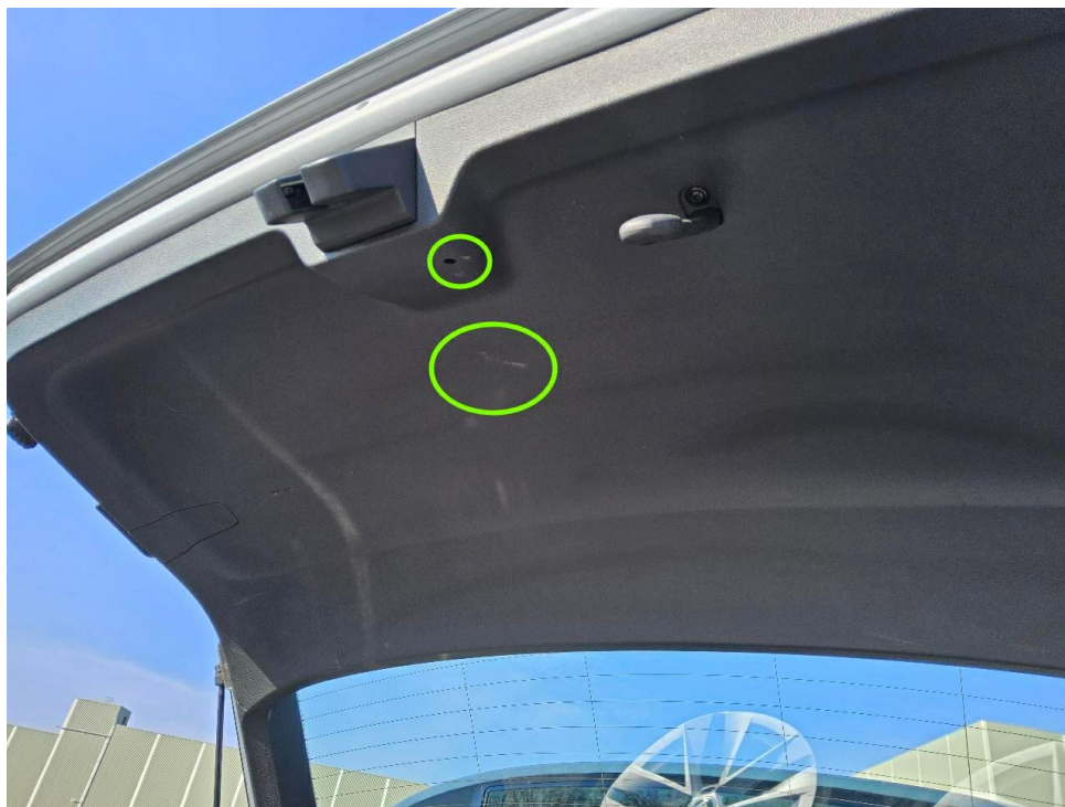
Bild 22 : Kofferraum Verkleidungen zerkratzt
