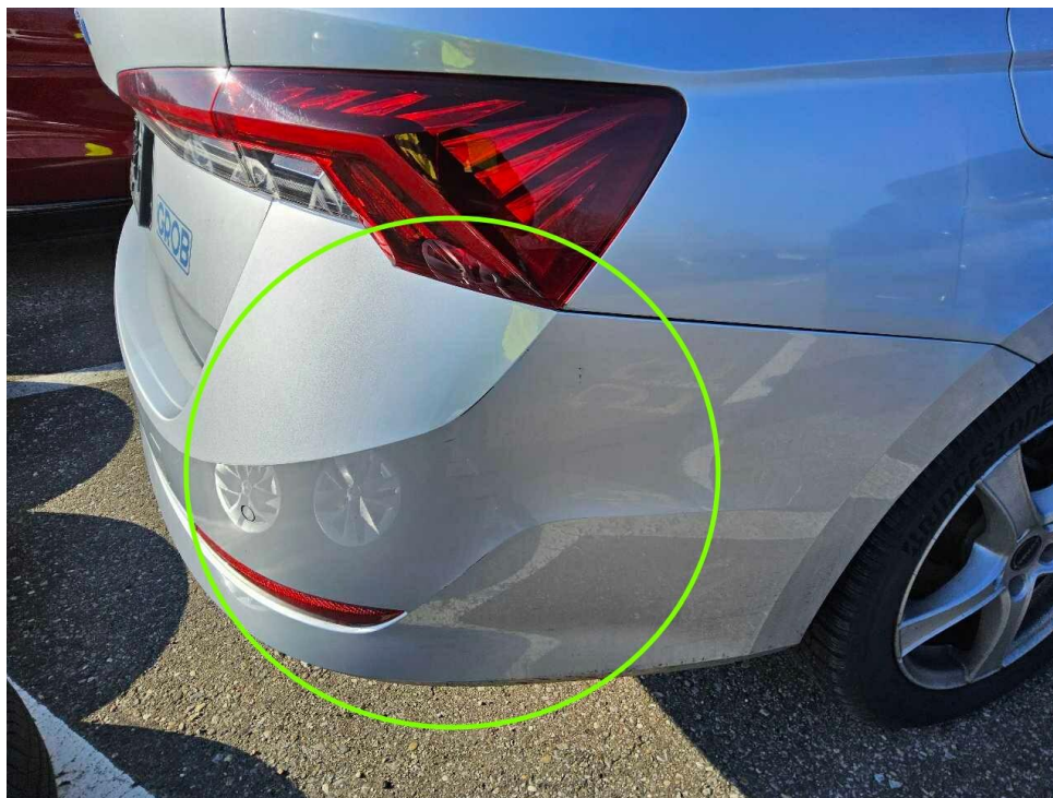
Bild 44 : Stoßfängerverkleidung hinten mehrfach verschrammt
