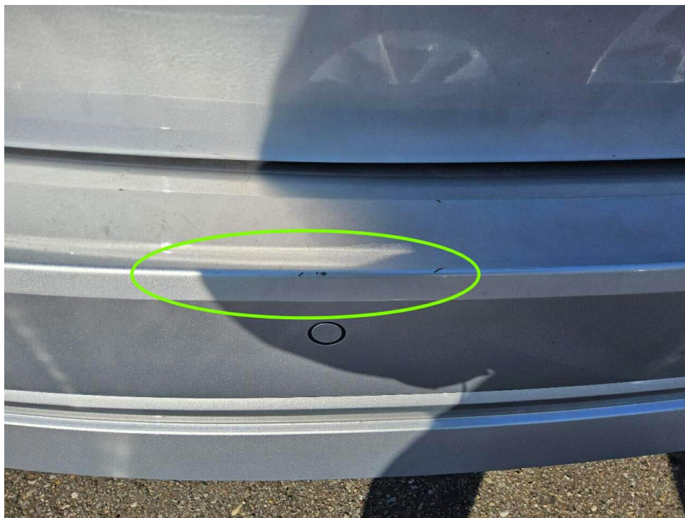
Bild 41 : Stoßfängerverkleidung hinten mehrfach verschrammt
