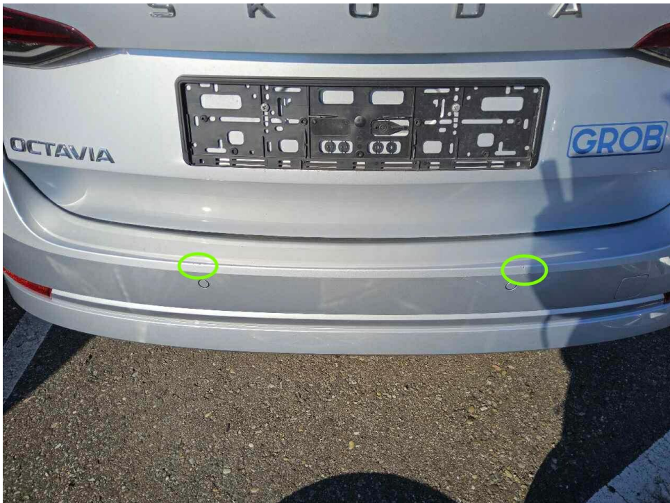
Bild 40 : Stoßfängerverkleidung hinten mehrfach verschrammt
