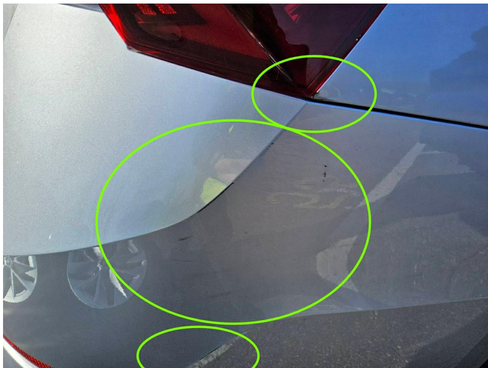
Bild 45 : Stoßfängerverkleidung hinten mehrfach verschrammt
