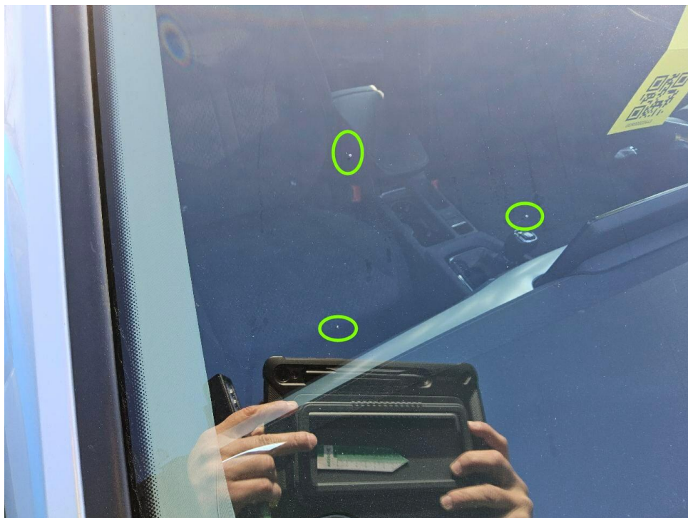
Bild 28 : Frontscheibe mehrere kleine Steinschläge
