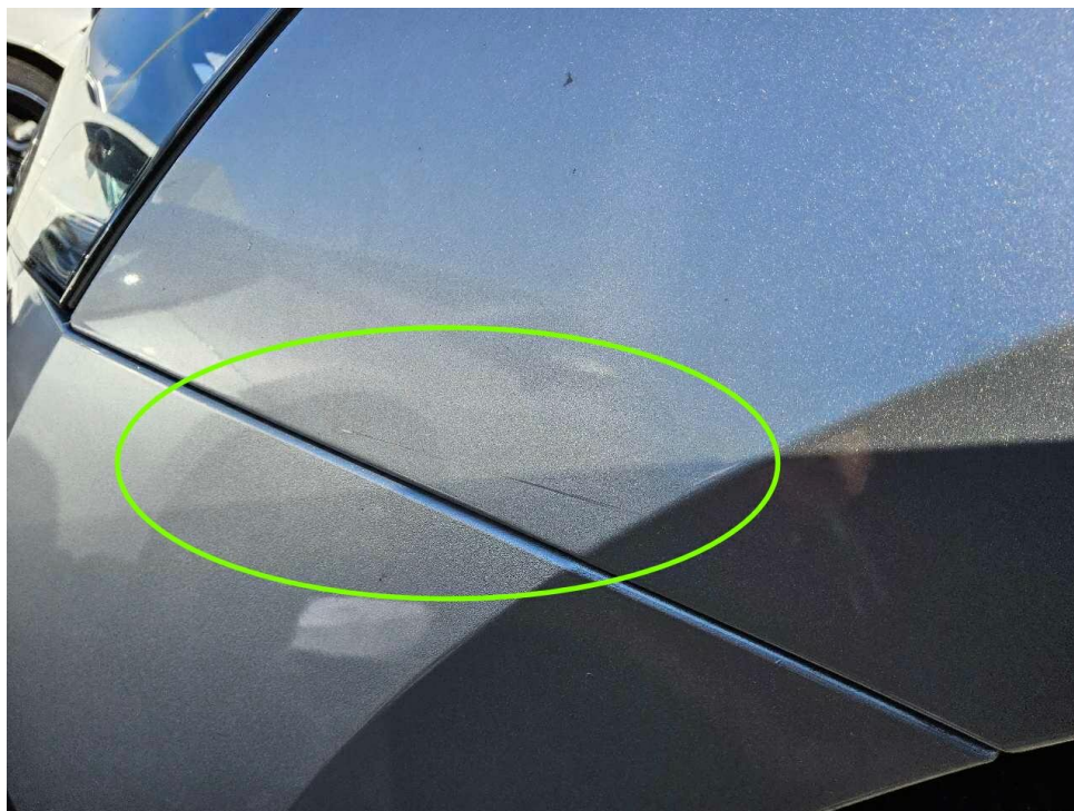
Bild 37 : Kotflügel vorne links Kratzer
