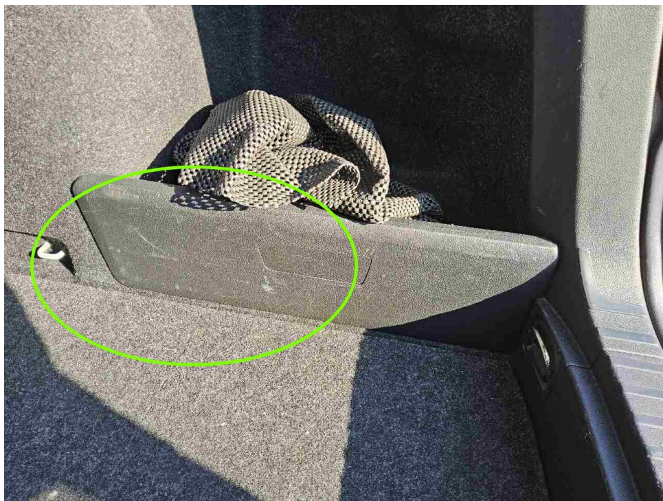
Bild 21 : Kofferraum Verkleidungen zerkratzt
