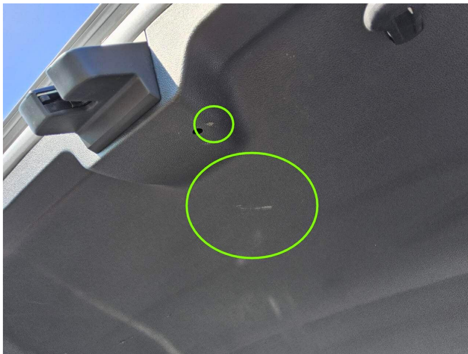
Bild 23 : Kofferraum Verkleidungen zerkratzt
