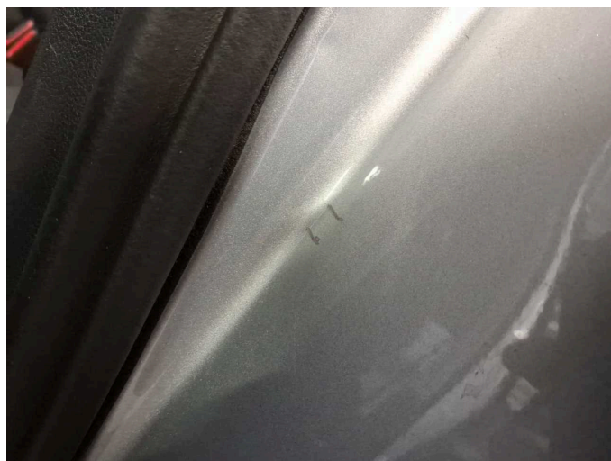
Beschädigung 1: Seitenwand links: Einstieg - Kratzer - Smart Repair
