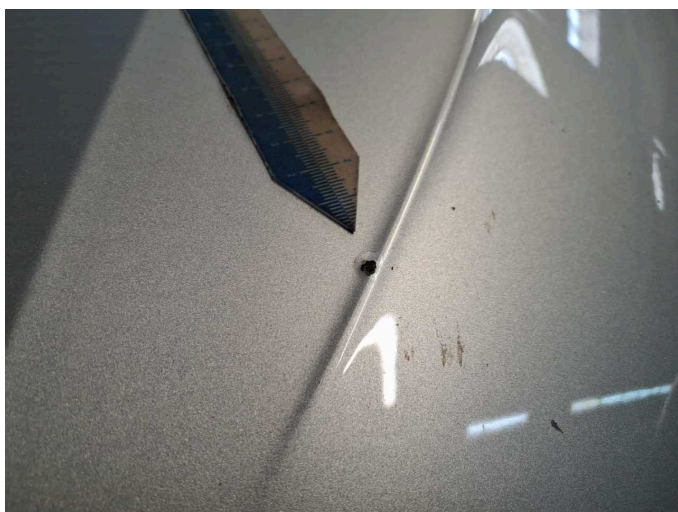
Beschädigung 7: Motorhaube: Motorhaube - Korrosion - lackieren
