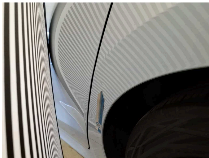
Beschädigung 4: Seitenwand links: Seitenwand - Delle(n) - sanft instandsetzen
