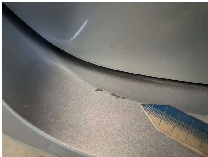
Beschädigung 5: Stossfänger hinten: Stossfänger hinten (Leicht eingedrückt) - verkratzt / verschürft - instandsetzen und lackieren
