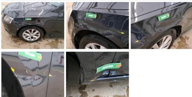
Porte AVG, Bosse(s) et griffe(s), LI - Réparer et peindre (complet)
