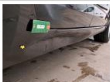
Bas de caisse ext D, Bosse(s) et griffe(s), Le - Remplacer et peindre
