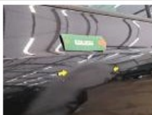
Bas de caisse ext D, Bosse(s) et griffe(s), Le - Remplacer et peindre
