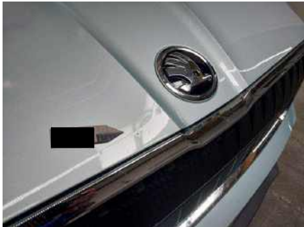
Bild 33: Motorhaube - Kratzer, Rost
