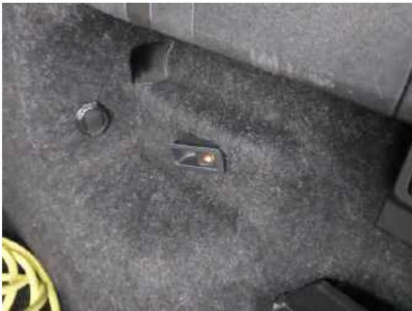
Bild 29: Schalter Anhängerkupplung beschädigt
