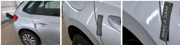
Porte ARD, Mauvaise réparation, Peindre
