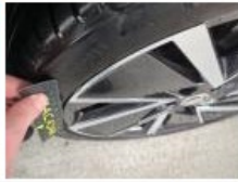
Jante alum. ARD, Griffe(s), LI - Réparer et peindre (complet)
