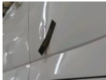
Porte ARG, Déformé / Forcé, LI - Réparer et peindre (complet)
