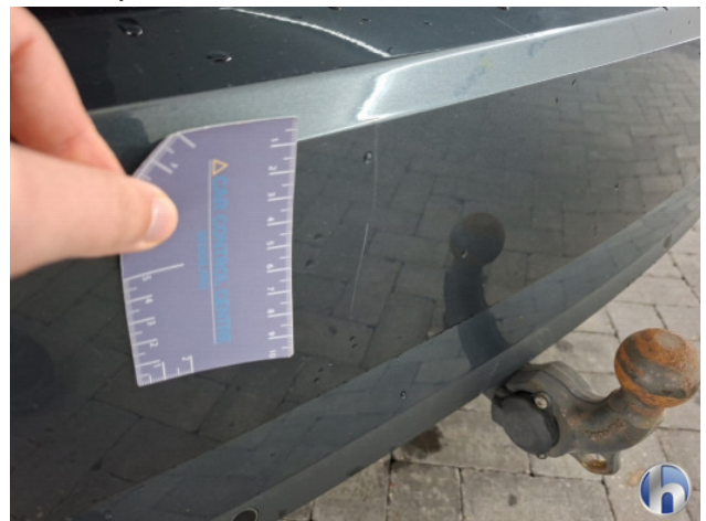
1. Diverse Gebruikssporen - Aanvaardbaar
