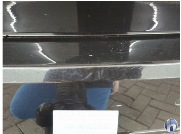
2. Achterbumper Gebruikssporen - Aanvaardbaar
