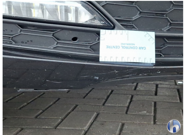
1. Voorspoiler Krassen - Spot Repair/Deelreparatie
