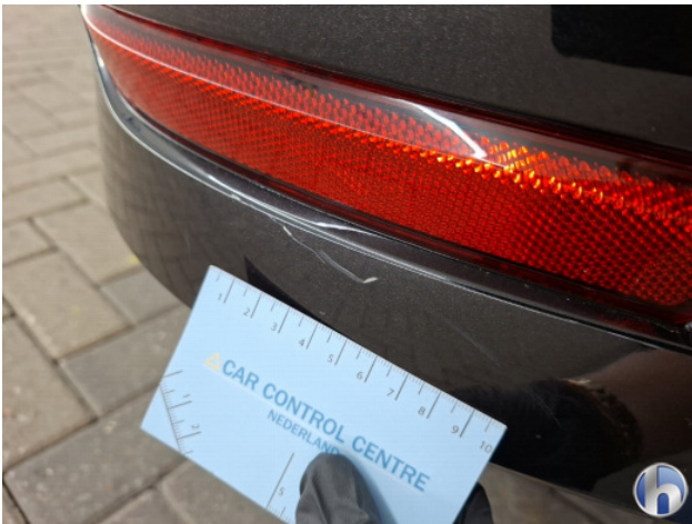
2. Achterbumper Gebruikssporen - Aanvaardbaar
