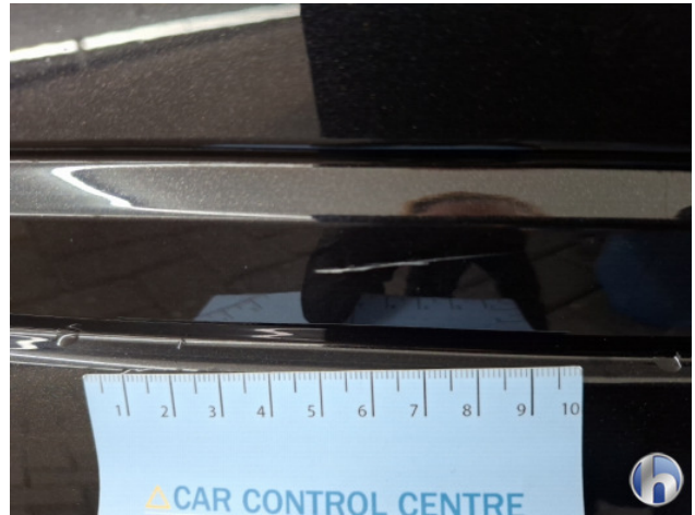
2. Achterbumper Gebruikssporen - Aanvaardbaar
