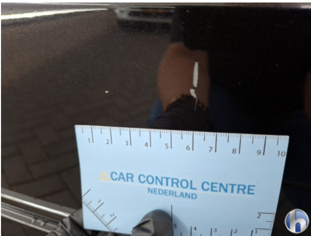
2. Achterbumper Gebruikssporen - Aanvaardbaar
