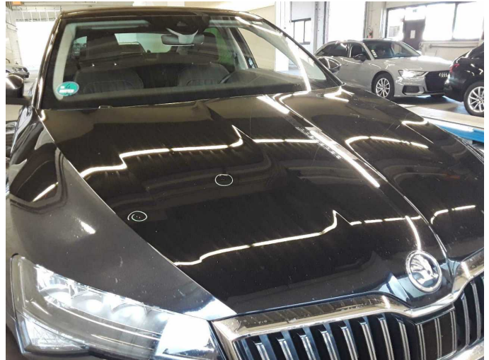
Damage 4: Bonnet: Bonnet (Vermehrte Steinschläge) - Stone chips - Paint
