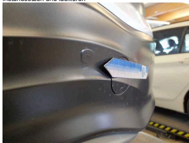
Beschädigung 2: Stossfänger hinten: Spoiler - verformt - instandsetzen und lackieren
