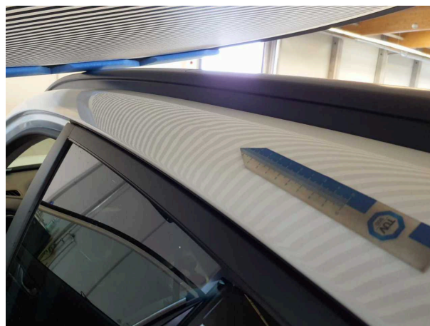
Beschädigung 1: Fahrzeugdach: Dachholm links - verformt - instandsetzen und lackieren
