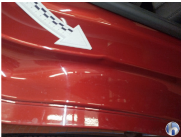
1. Türeinstieg Hinten - Rechts Verformt - Smart Repair 150,00 € / 150,00 €
