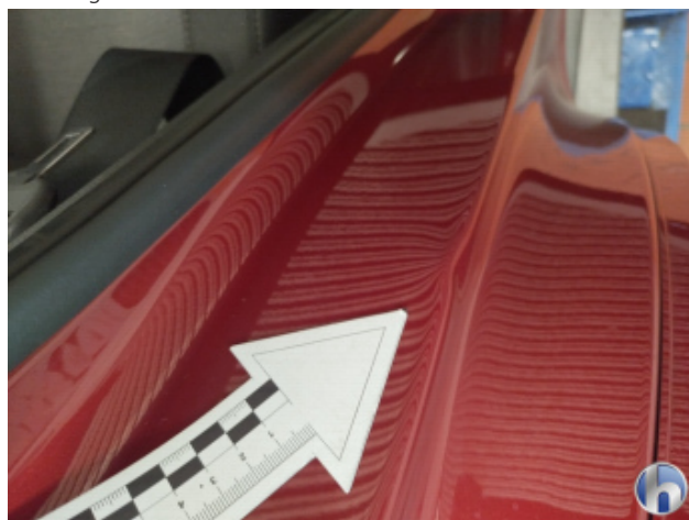
1. Türeinstieg Hinten - Rechts Verformt - Smart Repair 150,00 € / 150,00 €
