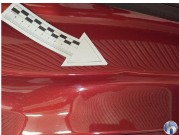
1. Türeinstieg Hinten - Rechts Verformt - Smart Repair 150,00 € / 150,00 €
