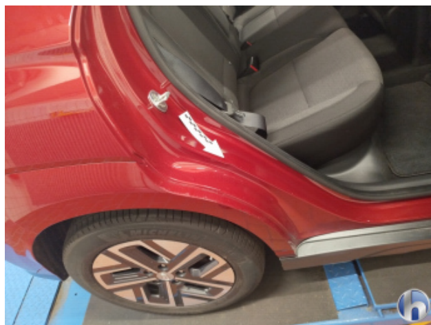
1. Türeinstieg Hinten - Rechts Verformt - Smart Repair 150,00 € / 150,00 €
