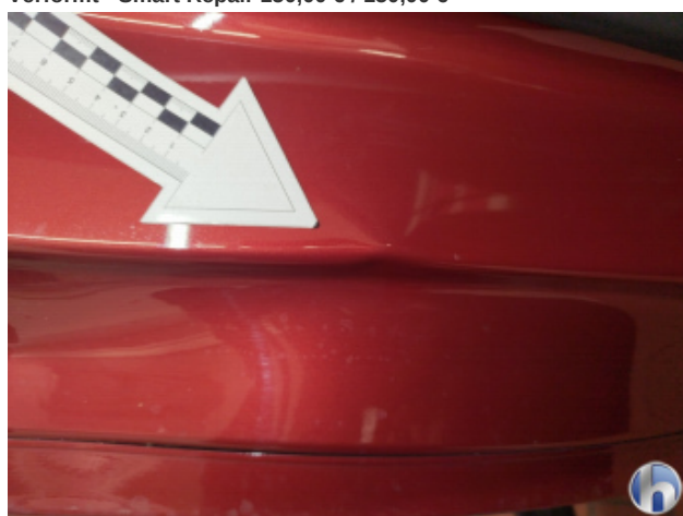
1. Türeinstieg Hinten - Rechts Verformt - Smart Repair 150,00 € / 150,00 €
