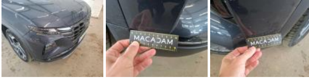
Moulure de pare-chocs AV, Déformé / Forcé, E - Remplacer
