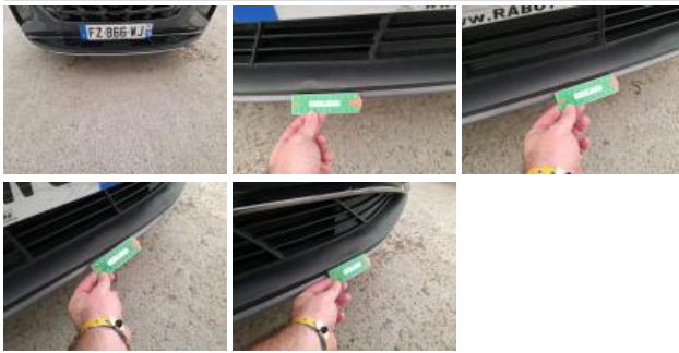
Moulure de pare-chocs AV, Cassé, E - Remplacer
