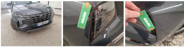
Spoiler AV, Déformé / Forcé, E - Remplacer
