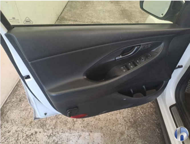
27. Front door trim - left
