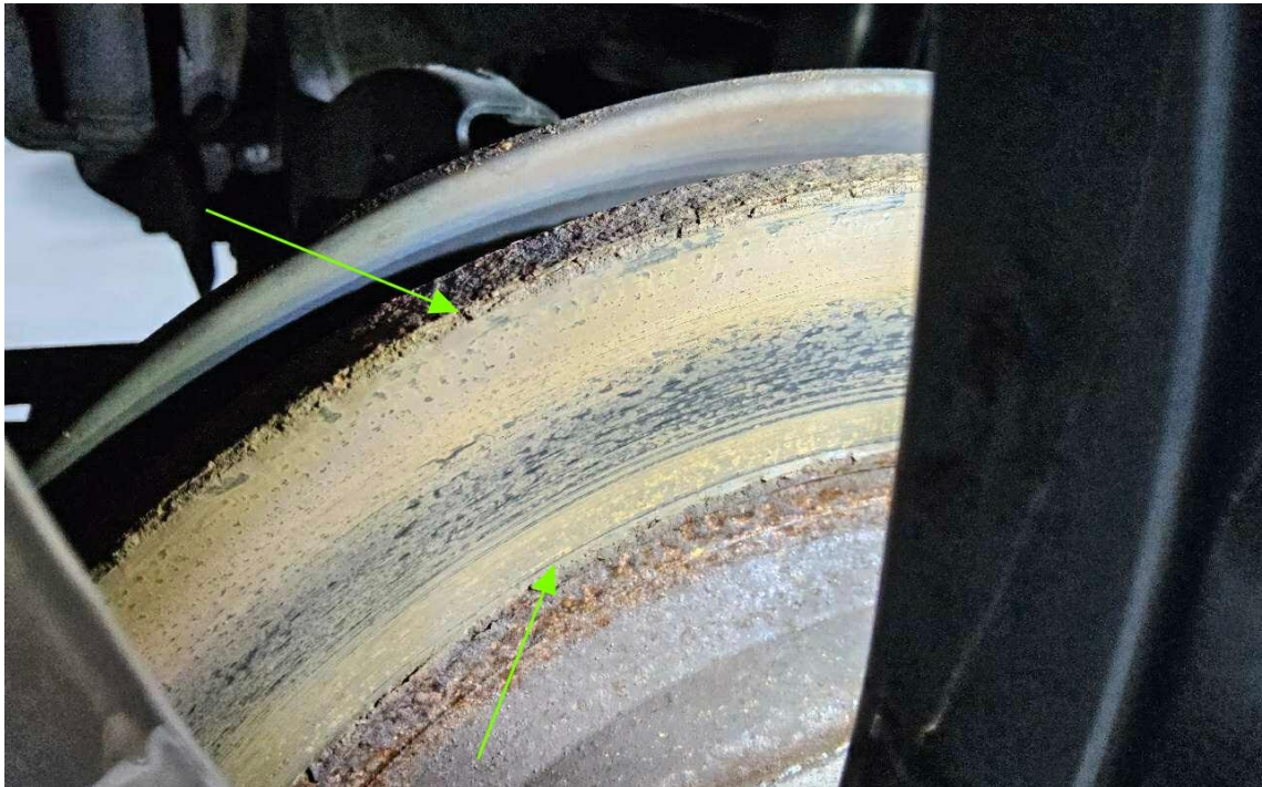
Bild 15 : starke Korrosionsbildung Bremse hinten
